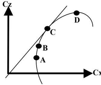
**12/ Un avion vole à 180 km/h. La surface alaire est de 15 m<sup>2</sup> tandis que le Cz est de 1,2. Sachant que la masse volumique de l'air est de 1,2 kg/m<sup>3</sup>, la portance est de :**
